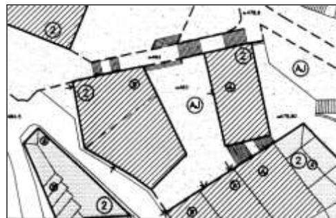
En este ámbito, que cuenta con 2.480 m<sup>2</sup> de superficie, se prevé una edificabilidad de 2.525 m<sup>2</sup> construidos en la edificación a renovar, sin incluir en esta superficie la correspondiente con la construcción a mantener marcada en planos.
